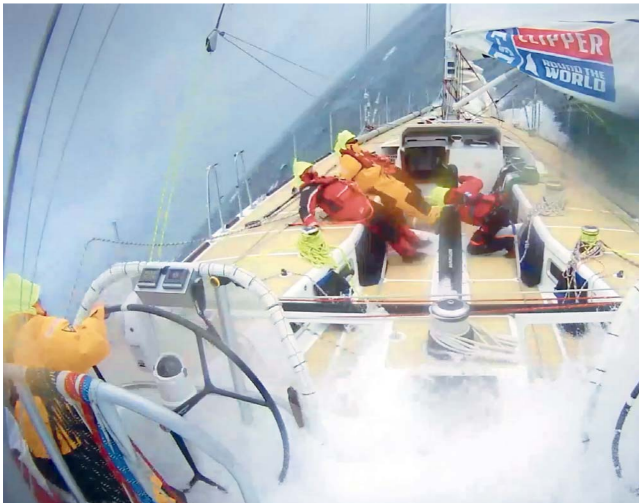
Alltag auf einer windigen Hochseepassage. Die Crew sitzt angeleint im Cockpit, als das Schiff überholt. Der Steuermann ist doppelt angeleint und hat einen "helm buddy" hinter sich, der hier nicht im Bild ist. Das Bild wurde einem Video vom Clipper Race entnommen
