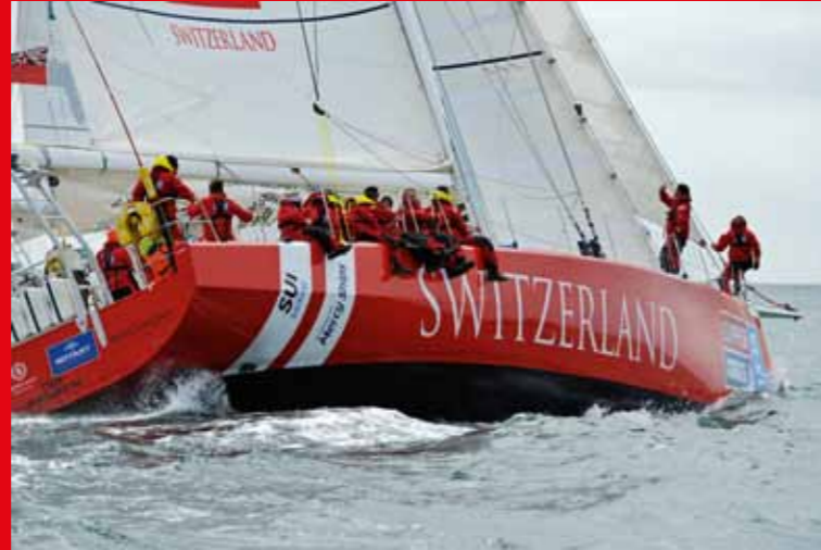
Bugspruit und ein prägnantes Heck mit Doppelrudern und Kimmkanten ("chines") - "SWITZERLAND" ist ein Clipper der 3. Generation. Auf der 3. Etappe wurden im Surf schon bis 30 Knoten Geschwindigkeit gemessen.
